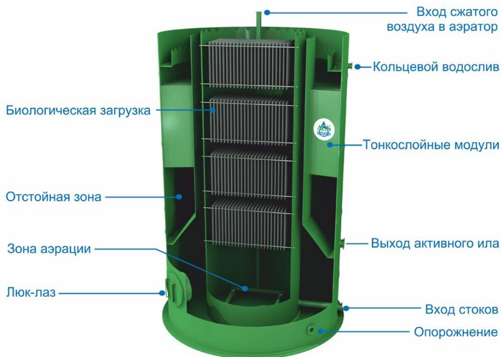
Рисунок 8 - Блок биологической очистки второй ступени - ББО-2
